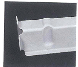
写真3 ハイドロフォームによるビード加工例
