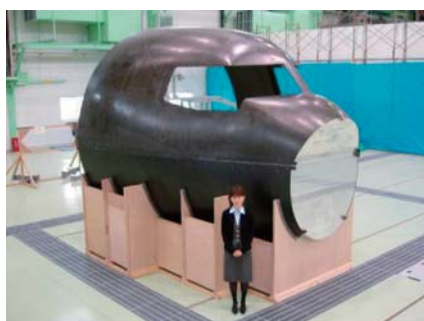
図8 実物大機首構造供試体の試作結果
