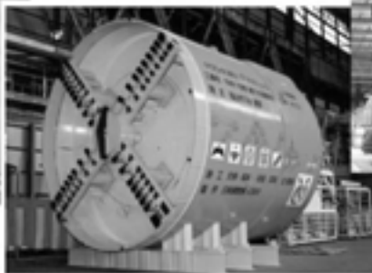
シールド掘進機
