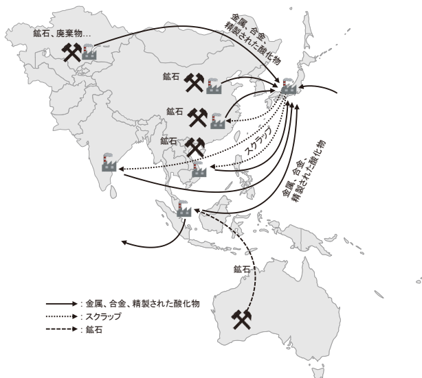
図1 レアアースなどの金属や合金を製造する場合やそのスクラップを処理する場合の世界的なマテリアルフローの概略 4)
